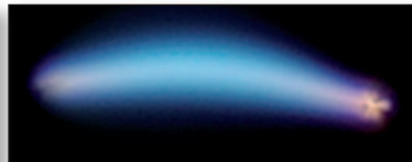
Décharge électrique à très haute pression dans un milieu H 2 /CO/He
